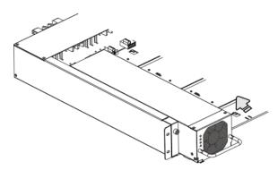
Figure 21. Insert the inverter module: step 1
